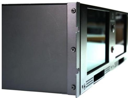
プラスドライバーで筐体にラックマウント金具をネジで取り付けます。
