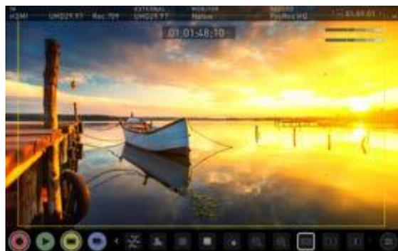
アクションセーフティエリアやタイトルエリアを有効にしますと、SMPTE規格に基づいたフレームガイドの比率で確認できます。ガイドを表示させるには、シネマガイドアイコンをタップして、希望の比率に変更します。アスペクト比マーカーのアナモフィックデスクトップ2倍は非常に便利です。セーフティエリアマーカーを適用するには、アクションエリアとタイトルエリアを1回タップします。
