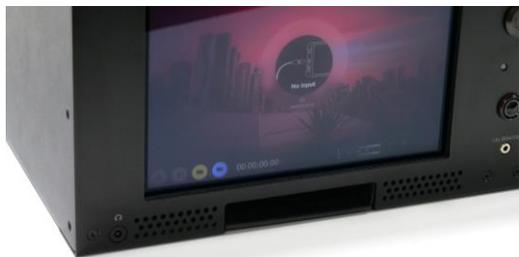
各チャンネルの液晶モニターの下にあるスロットが、記録媒体を挿入するメディアスロットです。
