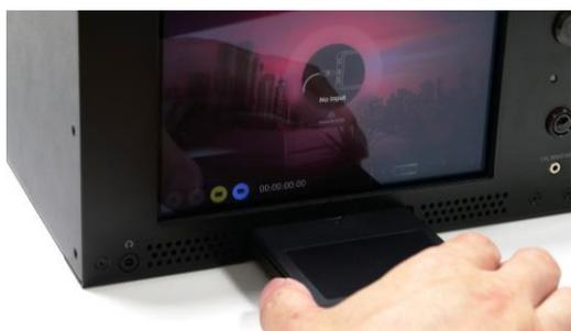
対応SATAドライブ（SSD等）をマスターキャディー2に納めてから（P.8参照）、このメディアスロットに挿入してください。挿入時にマスターキャディー2の両脇にあるスリットをメディアスロットのガイドと合っているか確認してください。
