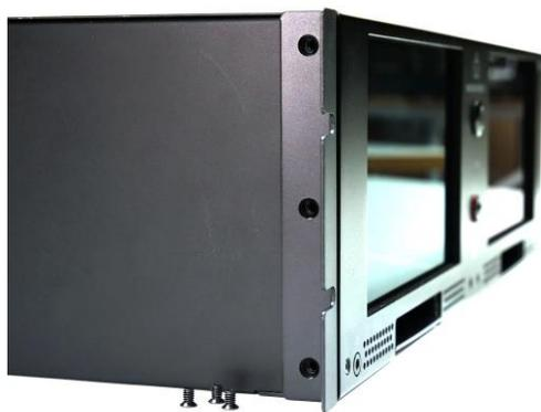
ラックマウント用金具の3つのネジ穴を筐体のネジ穴に合わせます。
