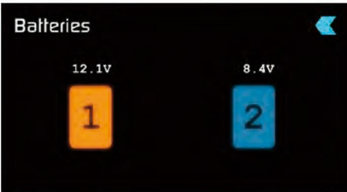
上記画像を確認して頂きますとバッテリー1はフル充電で起動中ですが、バッテリー2は1/4使用済みで起動していない状態です。バッテリーが装着されていない状態では右上の画像同様アイコンが黒く、中央にXと表示されます。
